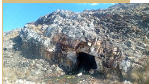
Estructura mineralizada de cuarzo-molibdenita (de hasta 2,5 m de ancho) en el corredor entre las minas Janchiscocha y Londres.
